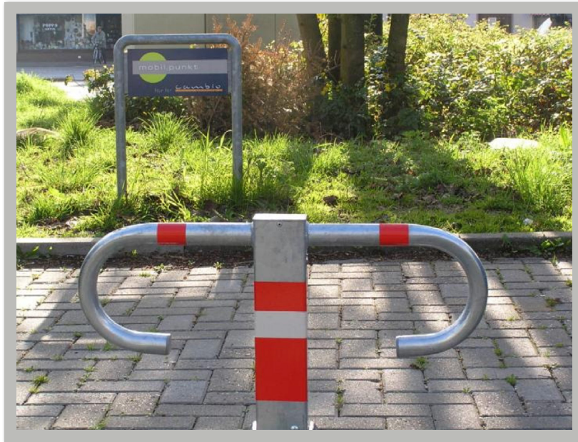
Beispiel Klapppoller als "geeignete bauliche Vorrichtungen" (mobil.punkt Am Dobben, Bremen)
